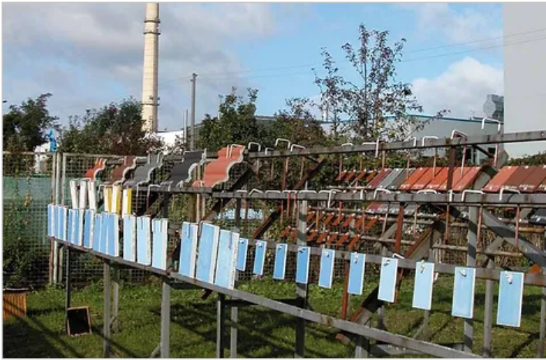
■ 屋外での暴露試験中の様子 ドイツ マグデブルグの工業地域で実施
